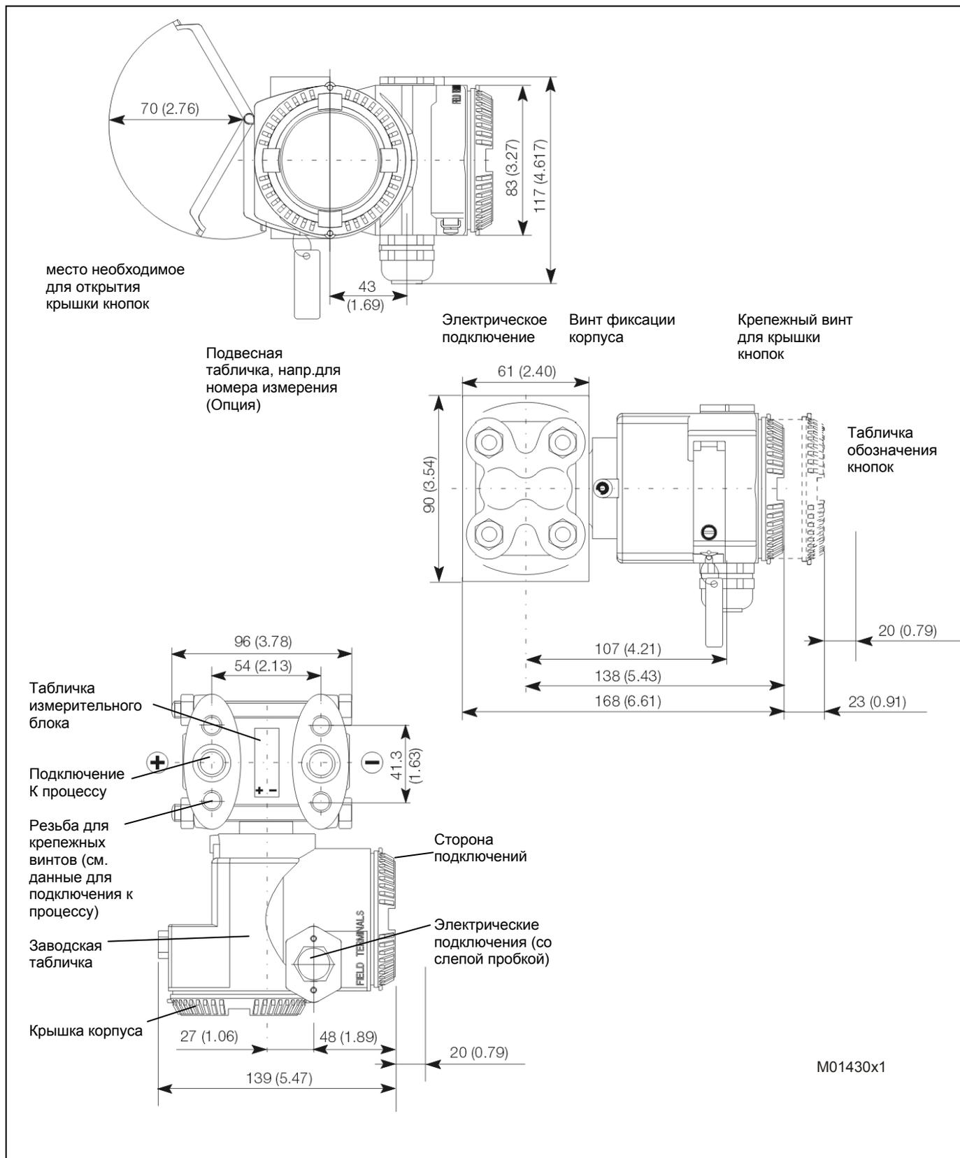
**Вариант монтажа с крепежной скобой**
